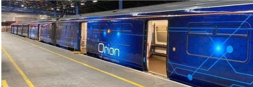
Orion startet mit modifizierten EMUs der Klasse 319 und Bi-Mode-Klasse 769 (4-teilige Triebwagen der Klasse 319, mit zwei zusätzlichen Dieselmotoren) = ca. 6 LKW. Letztere können im umgebauten Zustand bis 200 Rollbehälter befördern.
